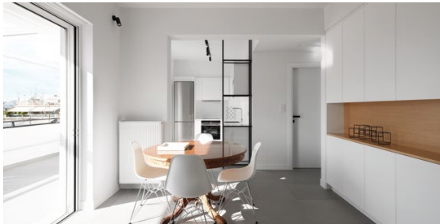
ΤΟ ΞΥΛΙΝΟ ΕΠΙΠΛΟ ΜΕΤΑΤΡΕΠΕΤΑΙ ΣΕ ΔΟΜΙΚΟ ΣΤΟΙΧΕΙΟ ΚΑΙ ΧΡΗΣΙΜΟΠΟΙΕΙΤΑΙ ΑΜΦΙΠΛΕΥΡΑ: ΑΠΟ ΤΗΝ ΤΡΑΠΕΖΑΡΙΑ ΚΑΙ ΑΠΟ ΤΟ ΧΩΡΟ ΤΗΣ ΑΠΟΘΗΚΗΣ.
